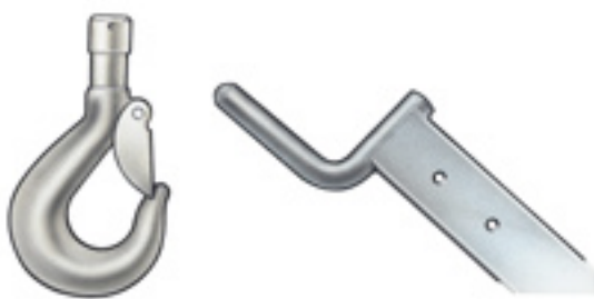
Løftekrogen skal have afrundede kanter. Skarpe kanter kan beskadige sækkens fibre og medføre risiko for, at den falder ned.
