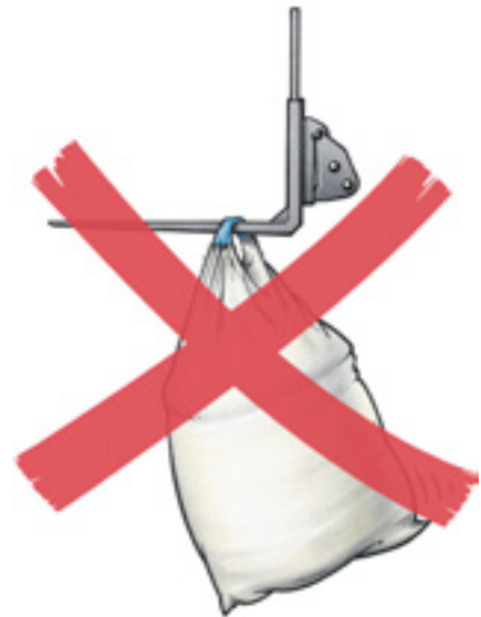
Brug aldrig en pallegaffel til at løfte storsækken, da dennes kant kan "skære" løfteøjet i stykker, hvilket medfører risiko for, at sækken falder ned.
