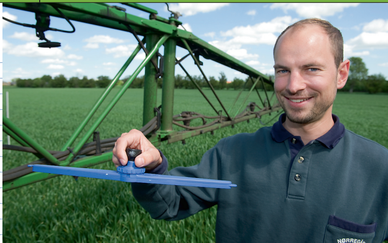
Driblerørene på sprøjten kan udsprøjtne fra 50 til 500 liter pr. hektar og egner sig godt til gradueret gødskning.
