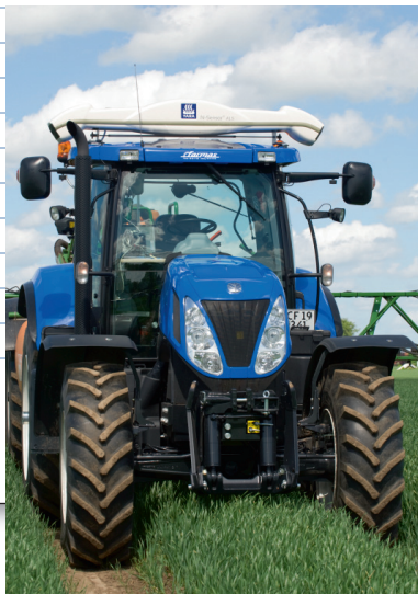
Den nye sprøjtetraktor med Yara N-Sensoren. Traktoren har Autostyring. Fotos: Jens Tønnesen
