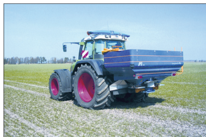
Yara N-Sensor er udviklet til graduering af kvælstofgødning. Systemet er nu under videreudvikling, så også sprøjtemidler kan gradueres med denne sensor-metode.
