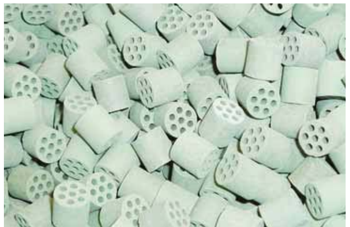
FIG 5: Katalysatorpiller. Ny rensningsteknologi udviklet af Yara, reducerer omkring 90 % af N 2 O-udledning ved produktionen.
